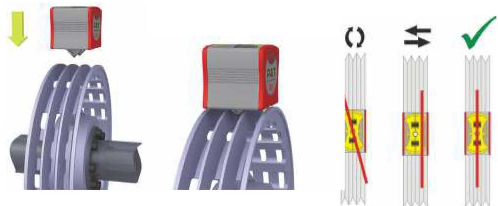
Fixturlaser PAT 单元可以非常方便地固定在带轮上，弹性触头寻找带槽中心，然后将两个测量单元压至带轮表面，激光单元自带的磁性底座也可很好的吸附在带轮表面上。
