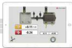
在水平方向调整，完成后重复测量并存储结果。
