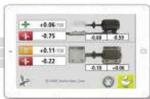
将探头盘车至6点钟位置，测量，对中测量结果会显示在屏幕上。
