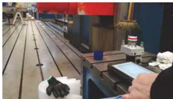
设备底座的矩形平面度测量
