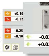
我们的专利图标和测量软件用不同的颜色等级区分测量结果，使得测量对中的过程变得简单。它在整个过程中引导用户，方便用户遵循各个步骤，它将根据系统在对中过程中获取的测量结果不断实时提供设备调整数值。
