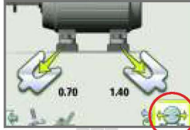
完成高低方向调整后，按下“实时数据显示”图标...
