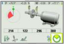
将探头盘车至第二位置，再次按下“测量”图标进行第二位置测量
