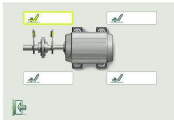
按照下图顺序，依次检测电机四个地脚的软脚数值
