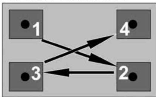
点击电机第一个地脚会显示如下：先松开地脚螺栓后再说锁紧螺栓，待软脚数值不变之后点击“OK”。
