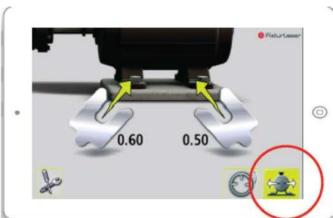
把探头转动到 9 点或者 3 点钟位置，可以实时调整设备的水平偏差，把探头转动到 12 点钟位置可以实时查看高低调整情况（参考对应的水平泡）
