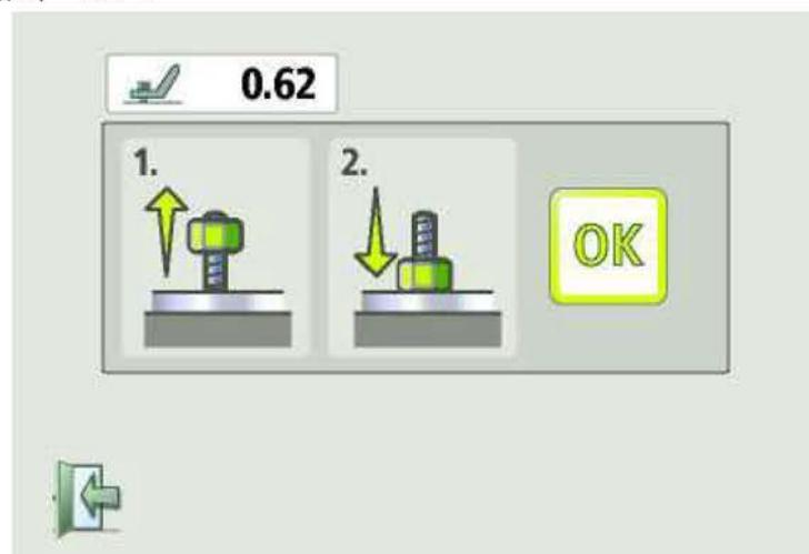
重复以上操作直到电机 4 个地脚软脚值测量完成。
