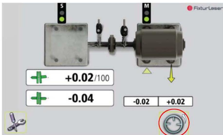
在调整值达到符合的对中要求时后，锁紧地脚并点击图标进行复查测量（还是转动探头至 9-12-3 位置并测量数据），确认设备在锁紧地脚后符合对中要求。
