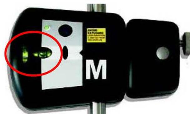
注意：因对中程序对测量角度有严格要求，探头必须到达对应位置（ $\pm 2^\circ$ ）才会出现可采集数据的图标，即探头外壳上的水平泡到达中间才能测量。
